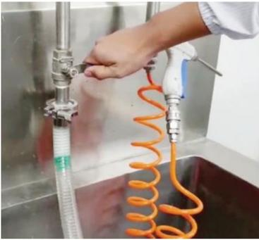
ErgoSCRUB 拭子端尖可以被拆卸来清洗USP软管
