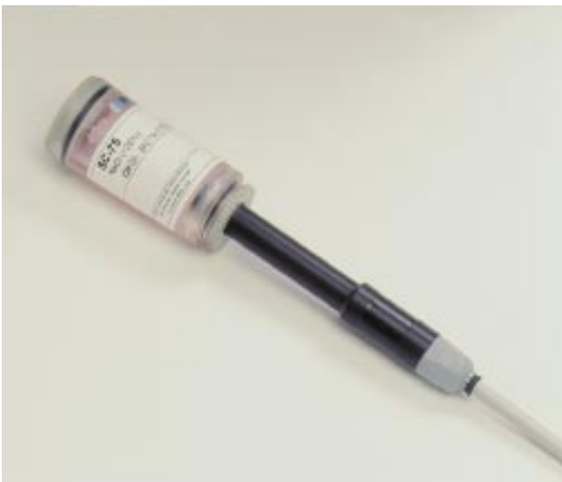
Hygrodat sensor with mounted sensor-check Hygrodat-Sensor mit angebrachtem Sensor-Check Capteur Hygrodat avec étalon
