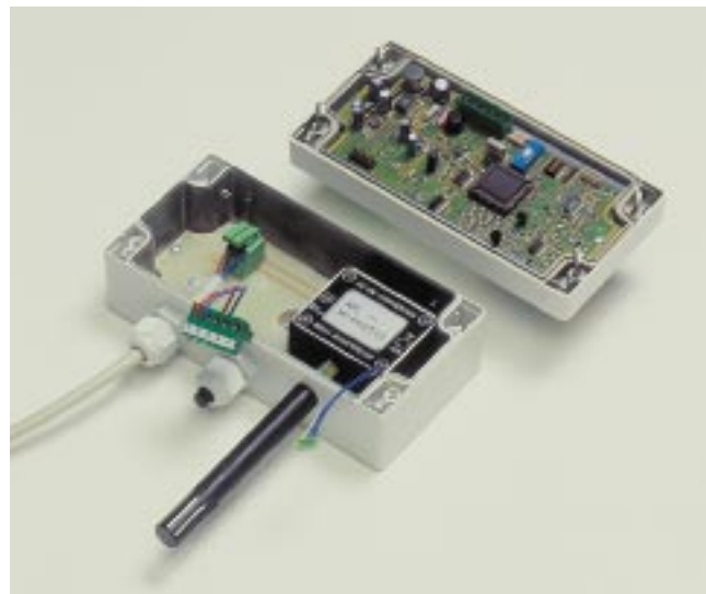
The electronics in the removable lid Die Elektronik im abnehmbaren Deckel L'électronique dans le couvercle
